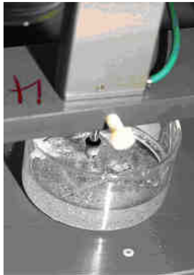
Détail du dispositif expérimental montrant le capteur de déplacement positionné sur la charge (plaque de verre) au-dessus du cristal dans une solution sursaturée. (photo J. Désarnaud).
