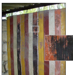
Figure 2: (a) Une des peintures murales expérimentales du LRMH. (b) Détail d'une zone présentant un noircissement du minium.
