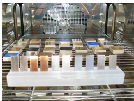
Echantillons dans l'enceinte de vieillissement
